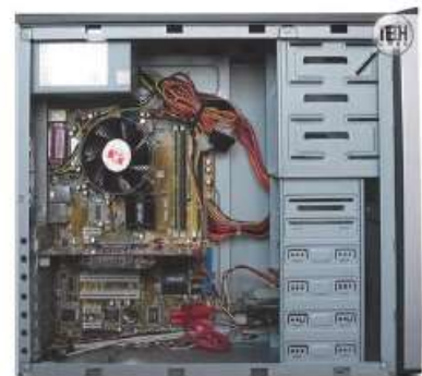
Նկ. 2. Համակարգային բլոկի ներքին կառուցվածքը
