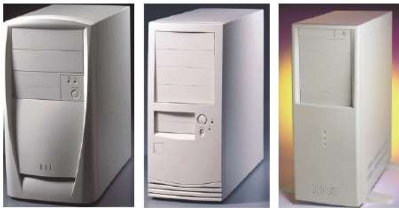
ա. Նկ.3. ա. Mini-Tower, բ. ATX ստանդարտի Midi-Tower և գ. Big-Tower տիպերի իրաններ
